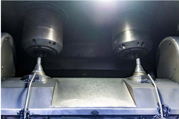
Bild 3: Auf dem zweispindligen Bearbeitungszentrum EMAG VSC 250 Twin werden die geschmiedeten Rohlinge hartgefräst.
