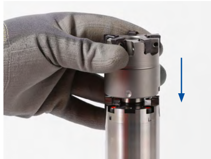
2. Den Fräseraufsteckdorn in eine Wechsellvorrichtung einspannen.
